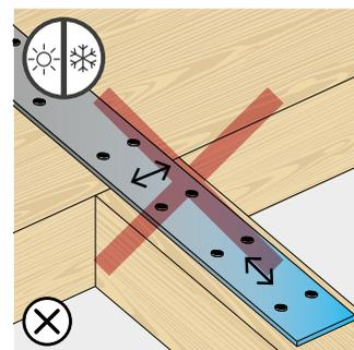
Избегайте размерных изменений металла, связанных, например, с сильными колебаниями температуры.
