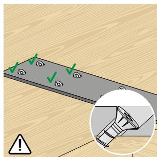
Монтаж должен выполняться таким образом, чтобы нагрузки распределялись равномерно по всем установленным шурупам.
