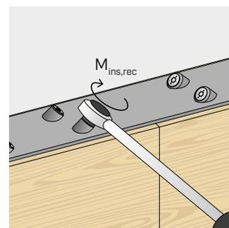
После установки крепежное изделие можно проверить с помощью динамометрического ключа.
