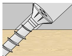
Наклонное расширенное отверстие.
