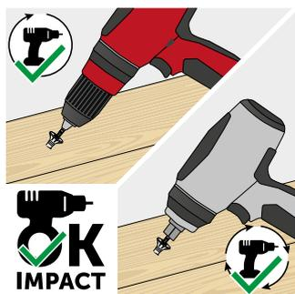
Для установки шурупов, используемых в конструктивных соединениях дерево-дерево (softwood), можно применять также импульсный или ударный шурупверт.
