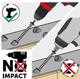
Использование импульсного/ударного шурупверта не допускается.
