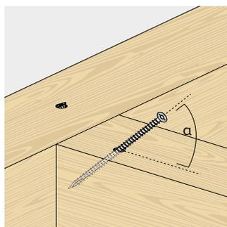
Соблюдайте угол установки, используя для этого пилотное отверстие и/или установочный шаблон.
