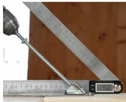
Для обеспечения контроля над крутящим моментом необходимо использовать правильную модель TORQUE LIMITER в соответствии с выбранным соединителем.
