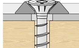
Цилиндрическое отверстие с расширенной шайбой HUS.
