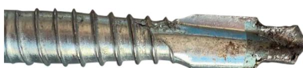
Наконечник, уменьшившийся в размерах при сверлении из-за высокой твердости пластины.
