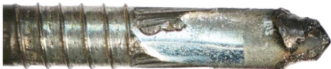
Наконечник, расплавившийся при установке на слишком твердую пластину без прокладок между деревом и пластиной.
