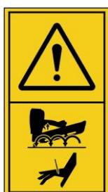
Не оставляйте палец на спусковом крючке, когда кладете инструмент, перемещаетесь между рабочими местами, поскольку это может вызвать непроизвольное срабатывание инструмента. При наличии режима работы по прижатию, убедитесь в работоспособности механизма перед использованием.
