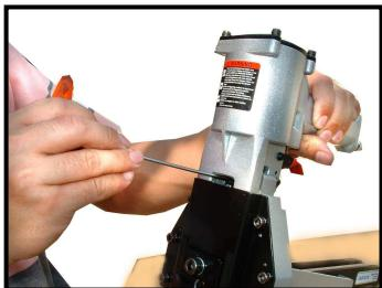
Шпилькой или отверткой поверните втулку (006) по часовой для большого сжатия или против для меньшего
