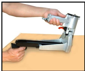
Потяните толкатель (032) назад до его остановки на штифтах (037). Затем поверните его вниз.
