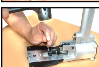
Выбейте шпильку (511) и снимите деталь (006) и пружину (005).
