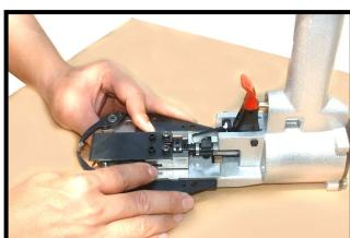
Выдвиньте механизм из корпуса (006).
